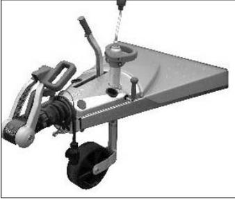
Klemmhalter (1) durch Linksdrehung des Klemmhebels (2) lösen.
