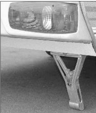
Die vorn und hinten unter dem Aufbau befindlichen Standstützen können mit Hilfe der beigegeführten Handkurbel stufenlos in der Höhe eingestellt werden. Die Handkurbel finden Sie vorn im Deichselkasten.
