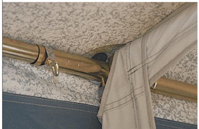
In den Mittelwinkel D und die Eckwinkel E und F werden Dorne eingesteckt, die die Zelthaut fixieren. Die Dorne haben eine Sicke. Immer den längeren Teil des Dornes in das Gestängerohr einstecken. Vergessen Sie nicht die Dichtungsscheiben **zwischen** Zelthaut und Gestänge einzusetzen.
