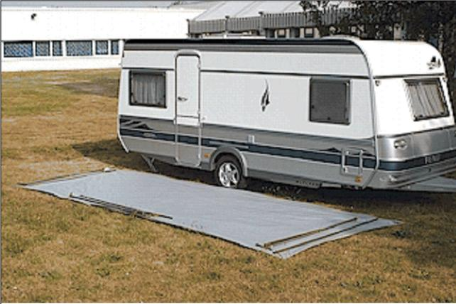
Nehmen Sie die Gestängeteile einzeln aus dem Karton. Sortieren Sie das Gestänge mit Hilfe des Gestängeplans. Die Stangen dort auf dem Boden verteilen, wo sie später griffbereit sind. Klemmschellen und Rohrfeststeller vorher montieren. Alle teleskopierbaren Stangen ineinanderschieben und leicht festklemmen.
