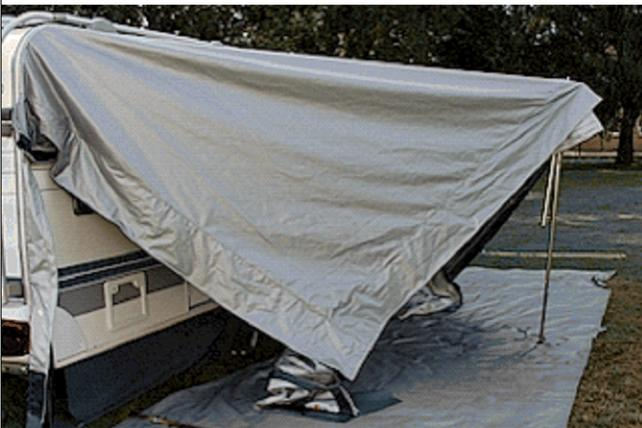
Bringen Sie den Mittelwinkel auf eine Höhe von ca. 200 cm und stellen Sie den Gestängefuß schräg nach innen. Dies stabilisiert das Dach und Sie können mit dem nächsten Schritt fortfahren.
