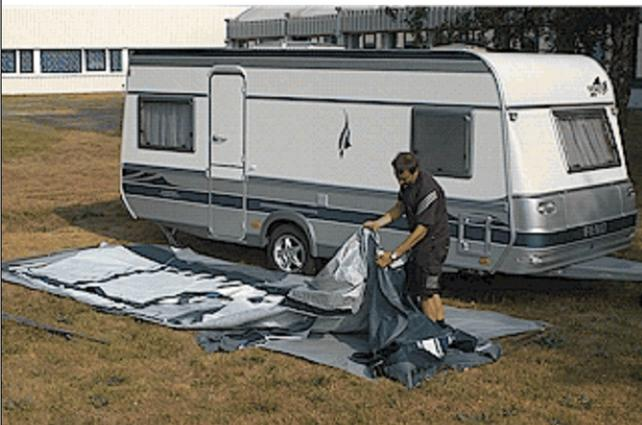
Nehmen Sie die Zelthaut aus dem Karton und legen Sie diese auf einer Plane auf dem Boden aus. Um Beschädigungen beim Einziehen der Zelthaut in die Kederschiene zu vermeiden, sollte zuerst nur das Dachelement eingezogen werden. Hierzu trennen Sie mittels der Reißverschlüsse alle Vorder- und Seitenwandteile vom Zelt Dach.
