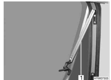
Bild 60 Ausstellfenster mit Automatik-Ausstellern, geöffnet
