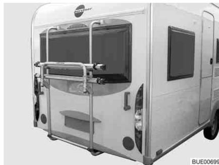
Bild 11 Fahrradträger an Heckwand
