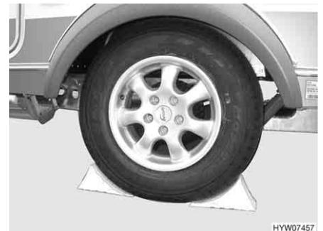
Bild 226 Fahrzeug sichern
