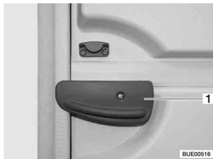
Bild 29 Verriegelungshebel am Türunterteil
