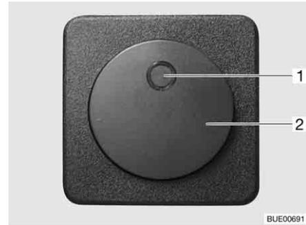
Bild 130 Schalter für elektrische Fußbodenheizung
