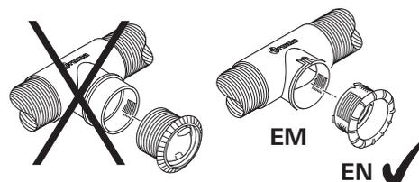
**i** La nueva pieza final y la antigua pieza en T del ventilador LT – y viceversa – no son combinables.
