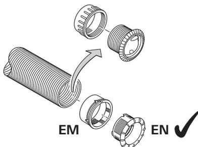
**i** Le nouvel embout et l'ancien écrou d'embout – et inversement – ne sont pas combinables.
