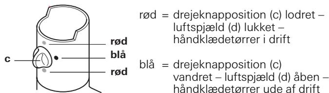
**!** Kontroller, at alle andre varmluftdyser er åbne for at udelukke en øget temperatur på håndklædetørreren!
