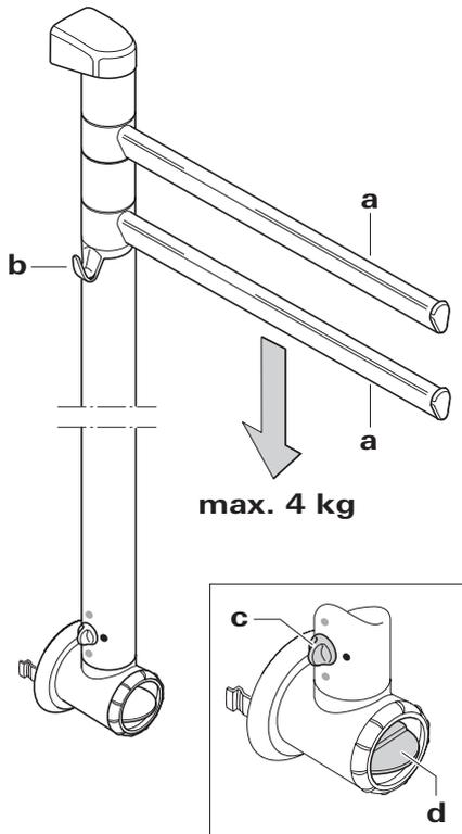
**a = schwenkbare Trägerrohre**
