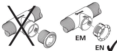
**i** Non è possibile abbinare il nuovo terminale al vecchio raccordo a T per ventilatore LT e viceversa.
