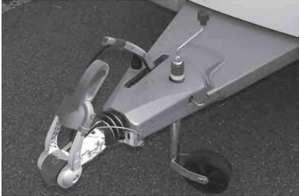
Der Caravan ist mit einer Antischlingerkupplung ausgerüstet nach ISO11555-1. Diese Sicherheitskupplung stabilisiert den Caravan während der Fahrt und sorgt damit für ein besseres Fahrverhalten.
