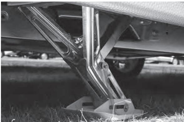
Die Ausdrehstützen befinden sich im hinteren und vorderen Bereich unter dem Caravan.
