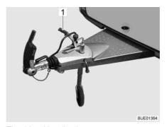
Fig. 18 Handbrake
