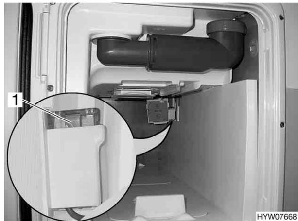
Bild 93 Sicherung der Thetford-Kassette (Variante 2)
