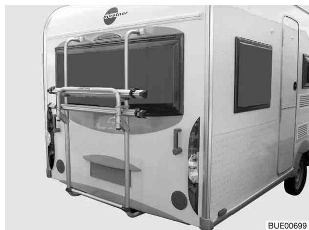
Bild 211 Fahrradträger an Heckwand
