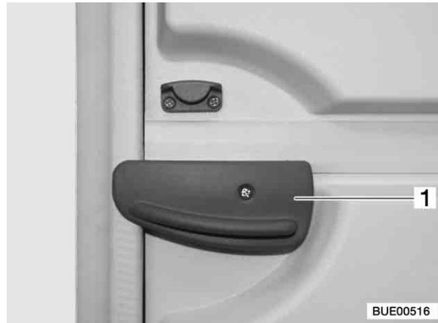
Bild 22 Türverriegelungshebel, Türunterteil
