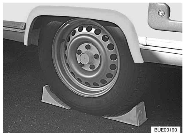
Bild 206 Fahrzeug sichern
