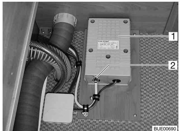
Bild 108 Trafo für elektrische Fußbodenerwärmung
